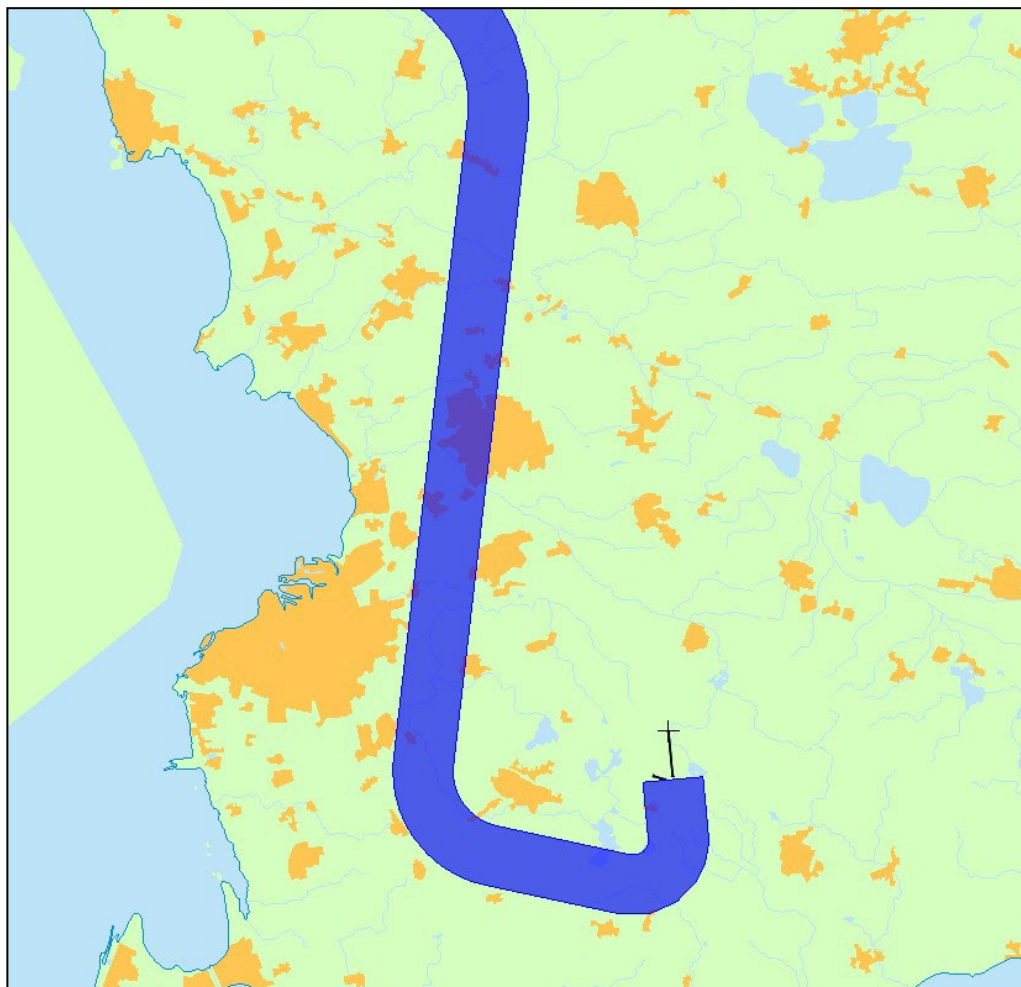
Figur 1: Kontrollzon för SID 17 BABS/ERNOV: definieras som +/- 1 sjömil kring det nominella spåret enligt AIP.
